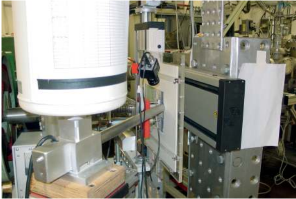
Abb. 2 Messaufbau der Niedrigenergie-PIXE (NE-PIXE).
