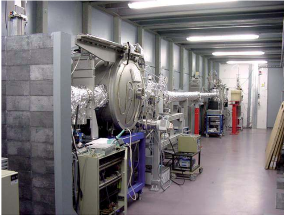
Abb. 5 Messaufbau der synchrotronbasierten Röntgenfluoreszenzanalyse (Sy-RFA).
