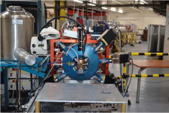
Abb. 2 Messaufbau am Teilchenbeschleuniger AGLAE für die Scanning PIXE im C2RME, Paris.
